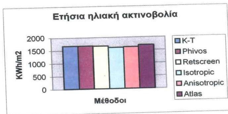
Διάγραμμα 7.4: Σύγκριση ετήσιας ηλιακής ακτινοβολίας σε κεκλιμένο επίπεδο με γωνία κλίσης \beta=10^\circ και γωνία αζιμουθίου \gamma=0^\circ για την περιοχή της Αθήνας ( \varphi=37,97^\circ ).
